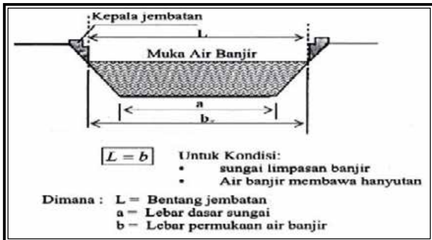
Gambar 12.12 Bentang jembatan untuk sungai limpasan banjir
