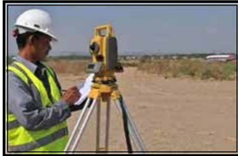
Gambar 10.6. Pengukuran theodolit pada permukaan datar
