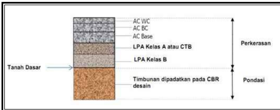
Gambar 7.4 Struktur Perkerasan Lentur pada Tanah Timbunan
