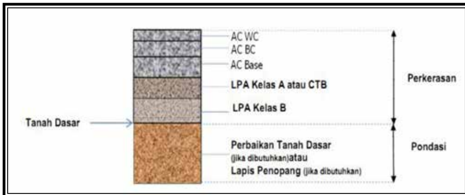
Gambar 7.3 Struktur Perkerasan Lentur pada Permukaan Tanah Asli
